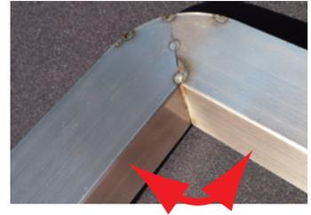
角パイプの内側を直角に曲げる要求にも対応できます。
